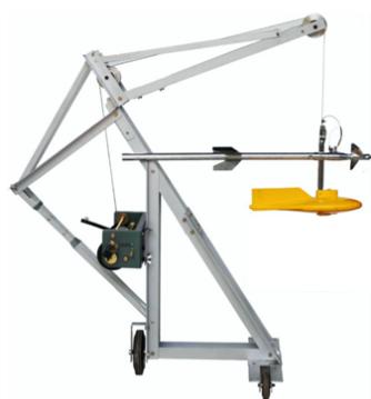
Bridge Crane yang terpasang suspended current meter
